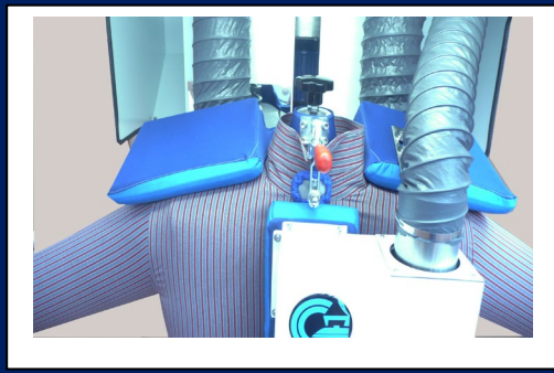
Sistema stira-spalle con RECUPERO ARIA CALDA Airbooster System ironing-shoulder with HOT-AIR RECOVERY Airbooster Système repassage Epaules avec RECUPERATEUR AIR-CHAUDE Airbooster
